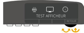
3 Tournez la molette dans l'un des deux sens jusqu'à obtenir « TEST AFFICHEUR » puis appuyez sur le bouton central pour démarrer le test.
