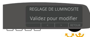
3 Tournez la molette dans l'un des deux sens jusqu'à obtenir « **RÉGLAGE DE LUMINOSITÉ** » puis appuyez sur le bouton central pour valider.
