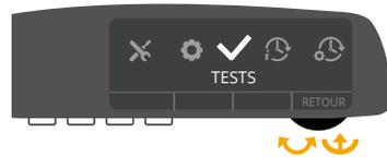
2 Tournez la molette dans l'un des deux sens jusqu'à obtenir « TESTS » puis appuyez sur le bouton central pour valider.
