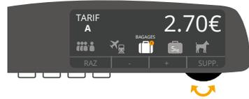
**2** Les suppléments apparaissent sous forme de liste déroulante de symboles. Pour naviguer dans le menu, tournez la molette dans l'un des deux sens. Le supplément sélectionné apparaît en surbrillance et son libellé s'affiche.
