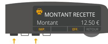
4 Appuyez sur **BP1** « **IMPRIMER** » pour imprimer l'ensemble des données. Appuyez sur **BP3** « **EFFACER** » pour effacer les totalisateurs partiels. L'icône « Imprimante » apparaît pendant la durée de l'impression.
