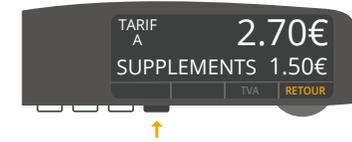
**4** La prise en compte de la modification est automatique et le menu « SUPPLEMENTS » disparaît automatiquement au bout de 10 secondes ou en appuyant sur **BP4** « **RETOUR** ».
